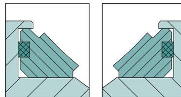
Уплотнение шара: Нерж сталь + твердое покрытие
