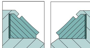
Уплотнение шара: Нерж. сталь + твердое покрытие
